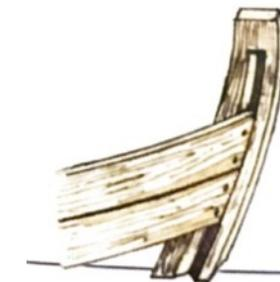
L'asta di prua aveva una scanalatura «**Battura**» per appoggiare e fissare le tavole della fiancata.
